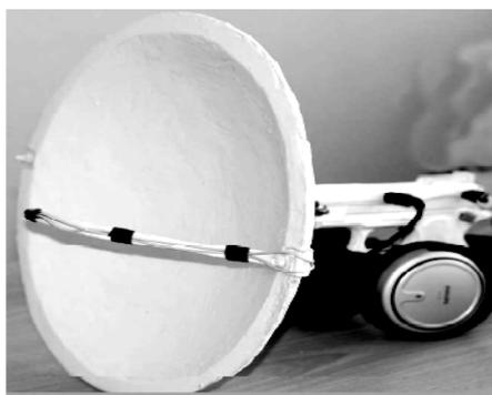
зеркала диаметром 30 см, и прикрепленной к нему ручки, внутри которой расположена электронная часть микрофона. Также на корпусе имеются разъемы для подключения головного телефона или соединительного кабеля с линейным входом в компьютер. Основные характеристики микрофона приведены в статье [1].
