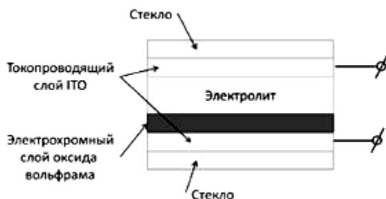
Рис. 1. Структура готового электрохромного устройства
