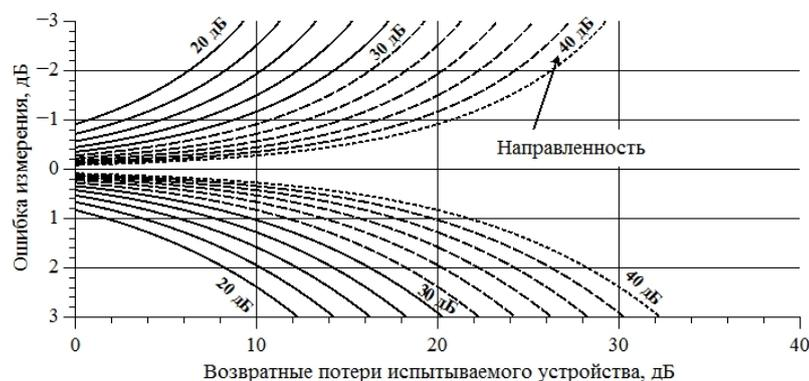
Рис. 3. Неопределённость измерения как функция поправки на направленность и значения возвратных потерь
