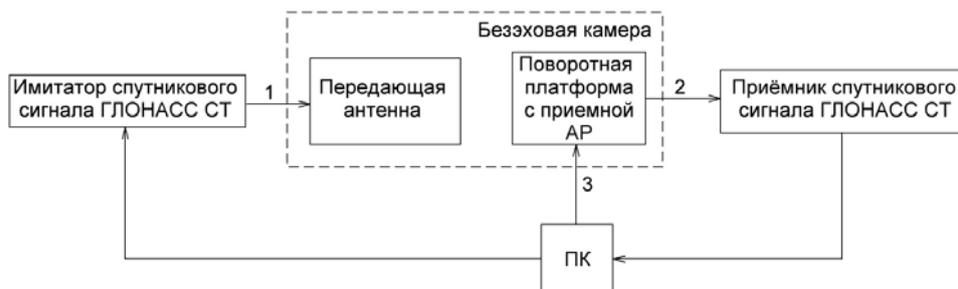
Рис. 3. Схема измерения ДН двухэлементной АР:
