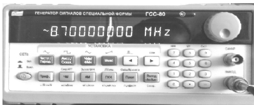
Рис. 3. Панель управления генератором ГСС80
