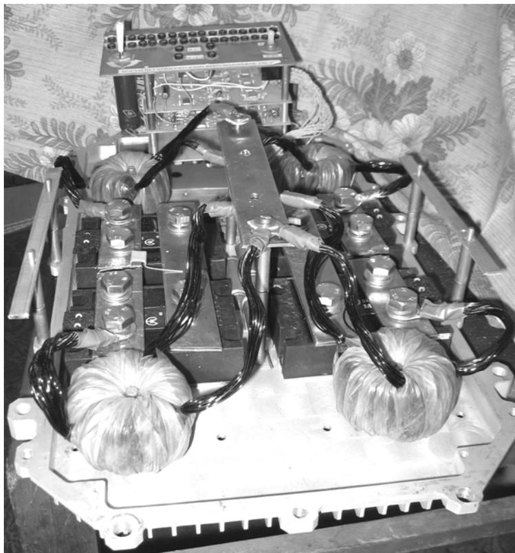
Рис. 1. Силовая часть 4-фазного ключевого стабилизатора
