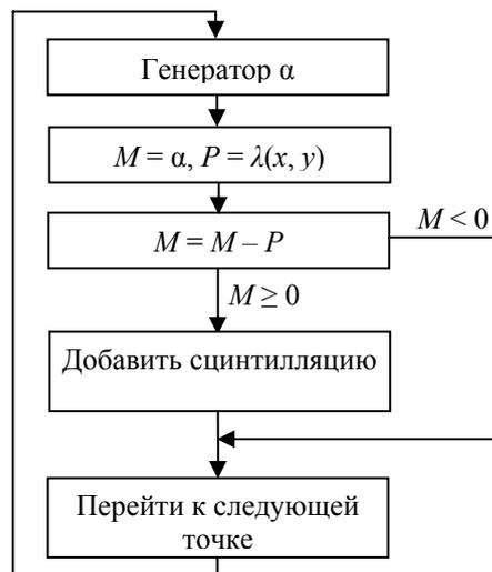
Рис. 5. Формирование сцинтилляции в точке  $(x, y)$
