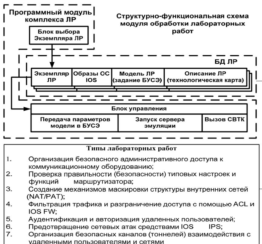
Рис. 2. Структурно-функциональная схема модуля обработки ЛР
