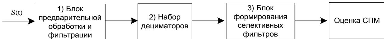
Рис. 2 – Структурная схема системы ЦОС
