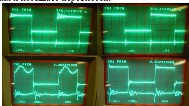
Рис.3 Выходное напряжение (верхний канал) и потребляемый ток (нижний канал)
