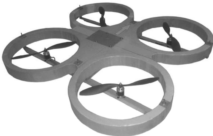
Рис. 1. Прототип квадрокоптера
