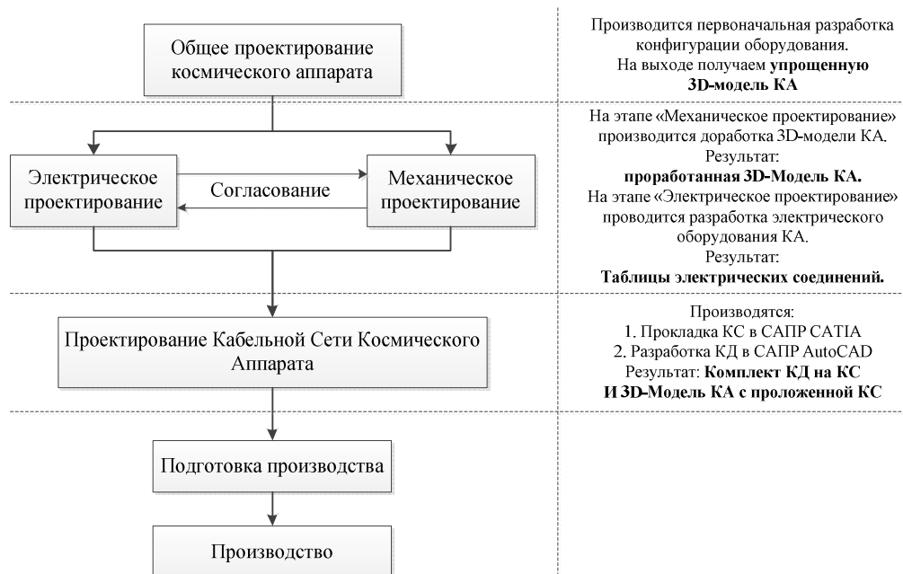
Рисунок 1 Общая схема проектирования космического аппарата по технологии 3D-макета «как есть»
