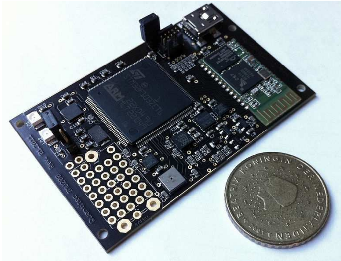
Abbildung 1 Kostengünstige Variante eines Inertial-Navigationssystems
