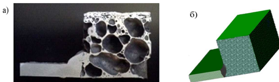
Рисунок 4 Результаты натурального и компьютерного экспериментов получения сварного соединения сплошного алюминия с пенодюралюминием: а – эксперимент, б – компьютерный эксперимент
