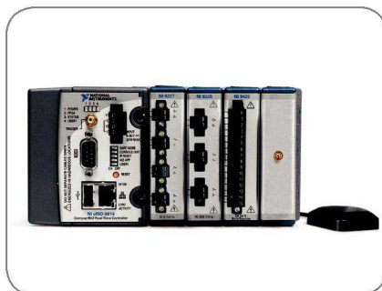
Анализатор качества электроэнергии и регистратор переходных процессов на базе NI CompactRIO
