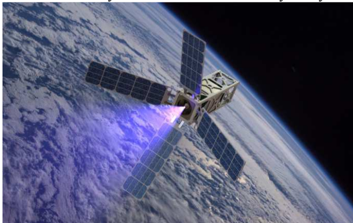
Рисунок 1 CubeSat с раскрывающимися панелями солнечных батарей
