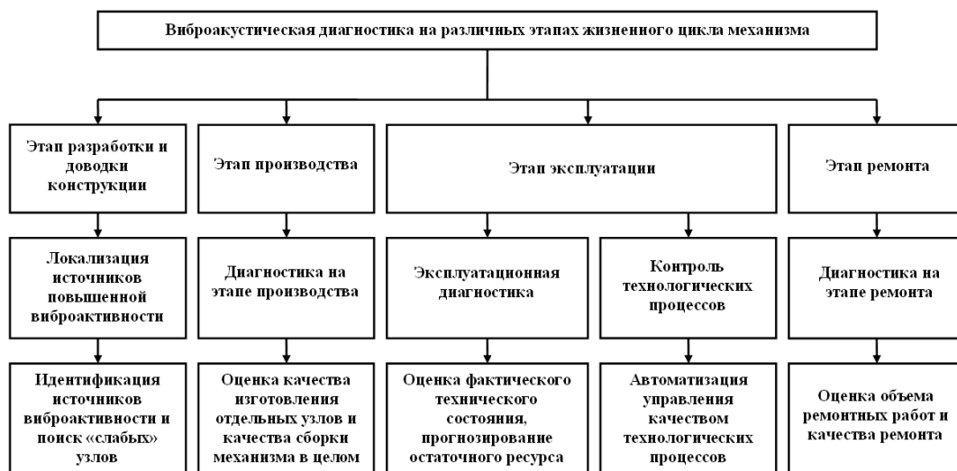
Рисунок 1 Области применения виброакустической диагностики на этапах жизненного цикла машинного оборудования
