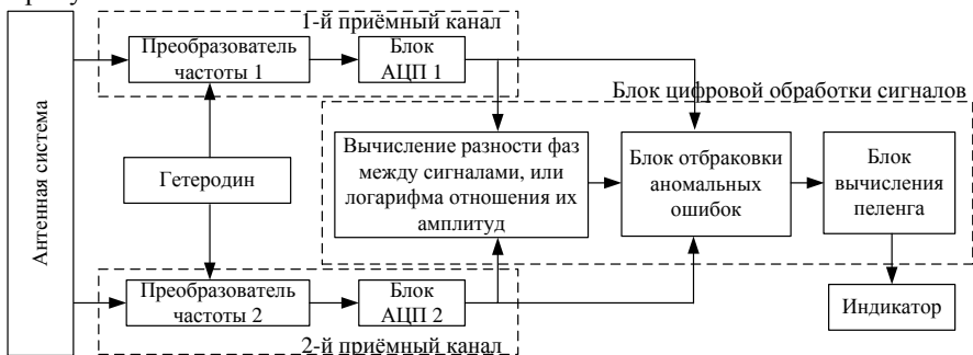
Рисунок 8 – Обобщённая структурная схема простейшего пеленгатора с блоком устранения anomalных ошибок пеленгования
