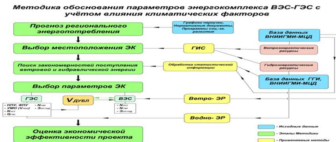
Рис. 1. Алгоритм реализации методики обоснования параметров энергокомплекса ВЭС-ГЭС с учётом влияния климатических факторов
