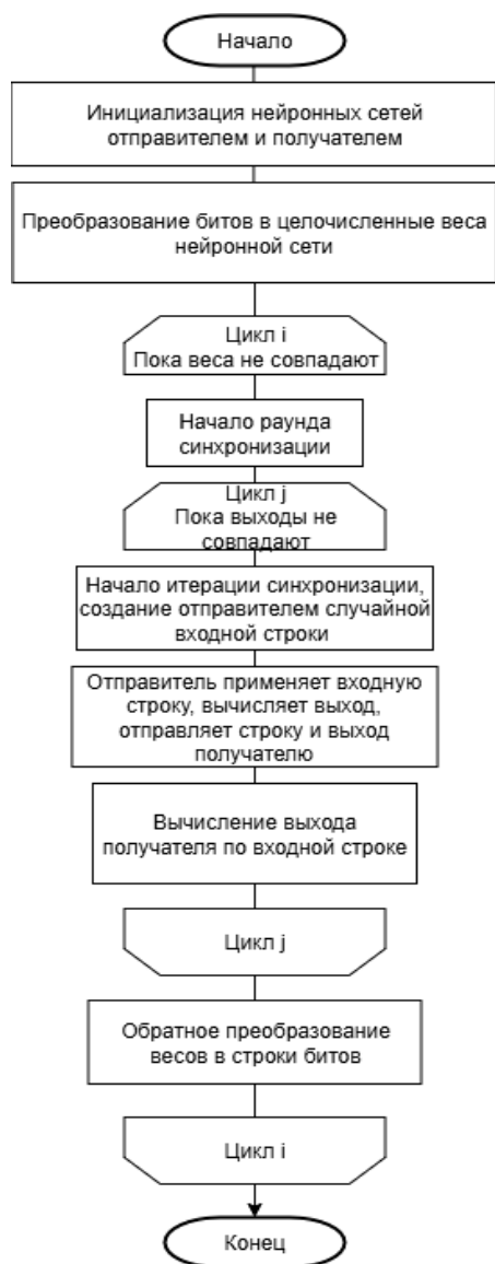
Рис. 2. Блок-схема обобщенного алгоритма согласования ключей с помощью нейронной сети
