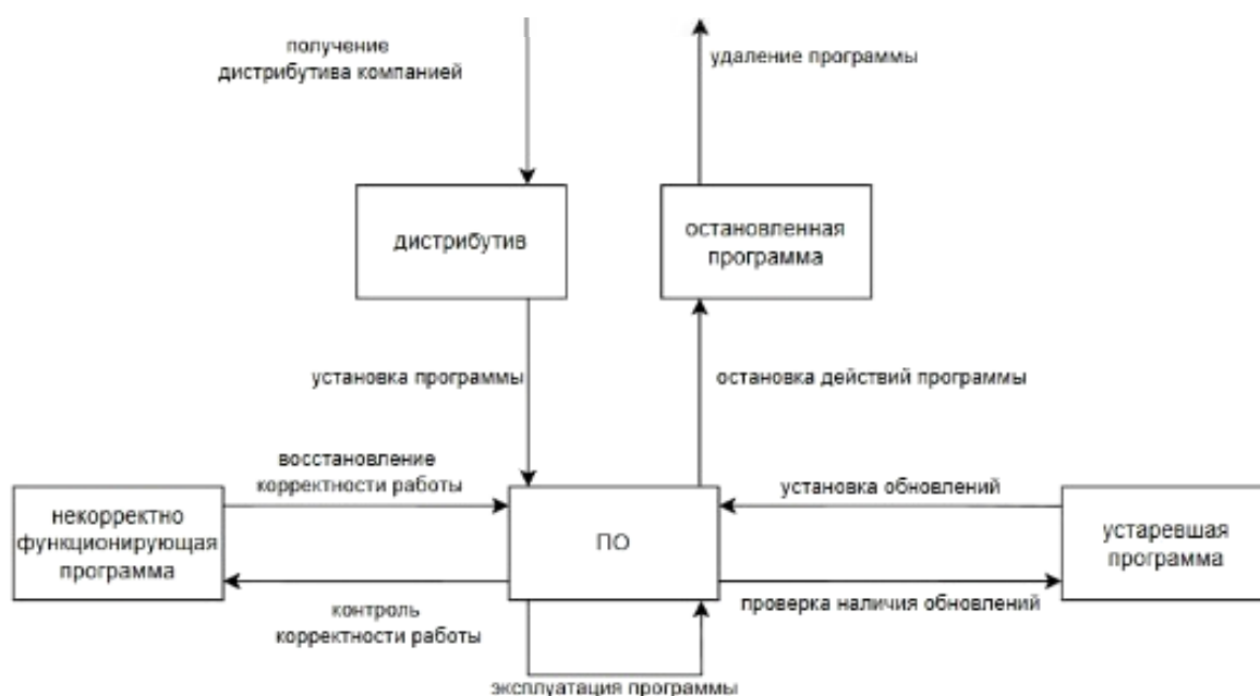
Рис. 2. Этапы эксплуатации программного обеспечения
