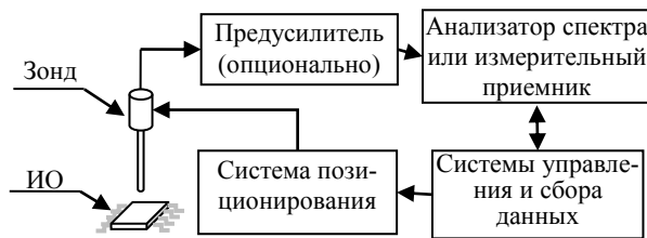
Рис. 1. Структурная схема установки для измерения уровня помехоэмиссии от ИО
