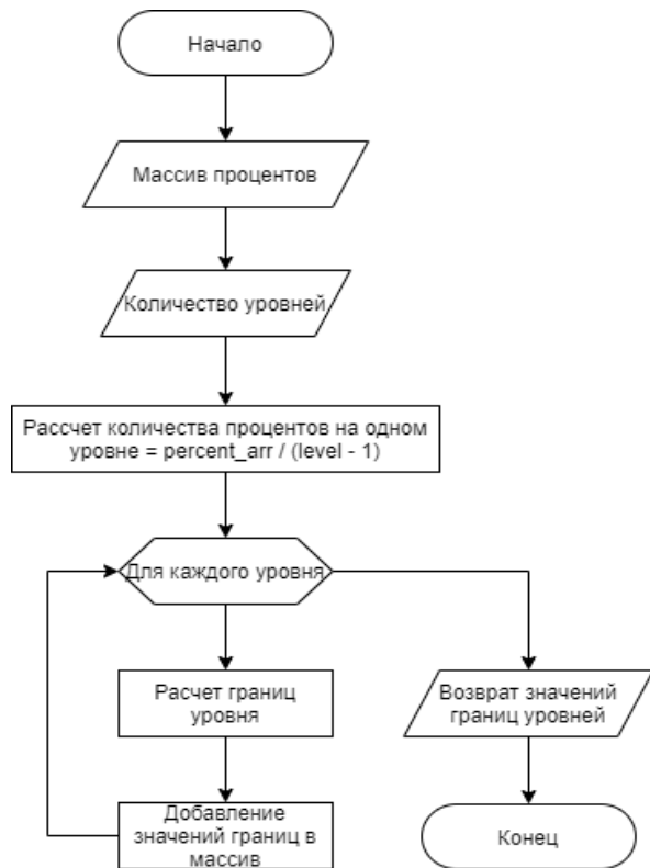
Рис. 2. Блок-схема расчета границ уровней
