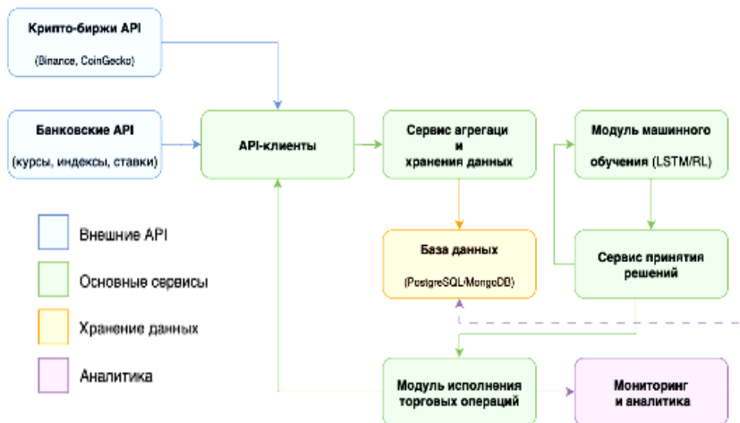
Рис. 1. Архитектурная схема автоматизированной торговой системы
