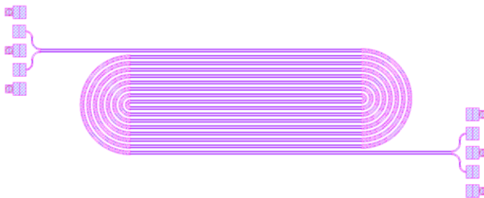
Рис. 1 (окончание). Поперечное сечение (а), эквивалентная схема включения (б) и двумерный вид интегральной линии передачи в виде спирал (в)
