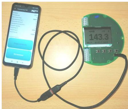
Рис. 2. Передача параметров с позиционера
