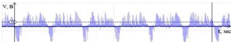
Рис. 3. Осциллограмма акустического сигнала вблизи импульсного трансформатора
