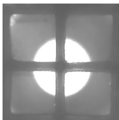
Рис. 2. Изображение светового пятна в идеальных условиях
