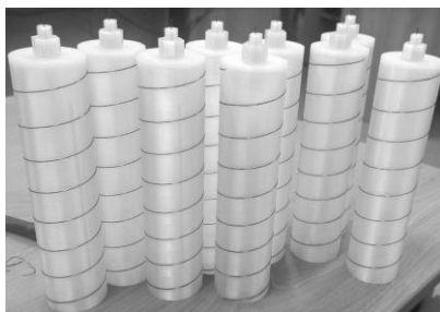
Рис. 2. Изготовленные спиральные проводники
