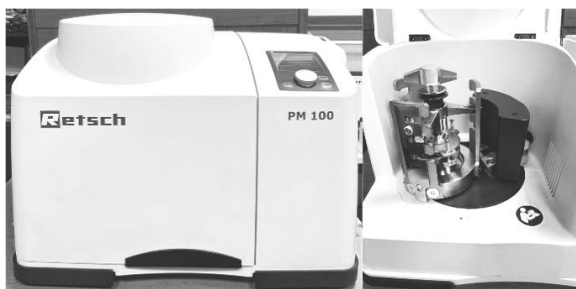
Рис. 1. Внешний вид планетарной шаровой мельницы PM100
