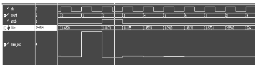
Рис. 2. Результат работы коррелятора с адаптивным порогом
