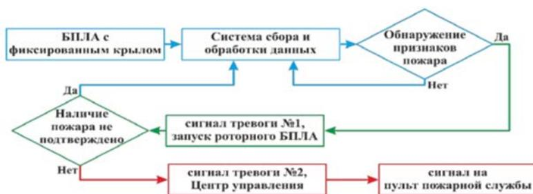
Рис. 1. Блок-схема системы раннего обнаружения лесных пожаров
