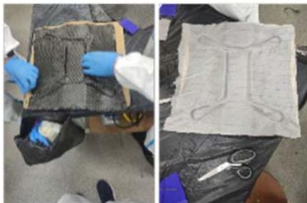
Рис. 3. Процесс укладки углеволокна в оснастку пакета
