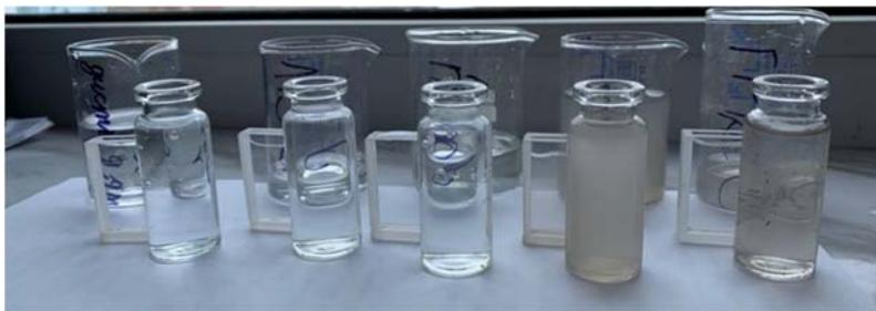
Рис. 4. Анализ мутности талой снежной воды
