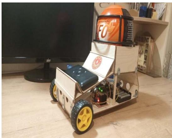
Рис. 1. Прототип робота-пожарника
