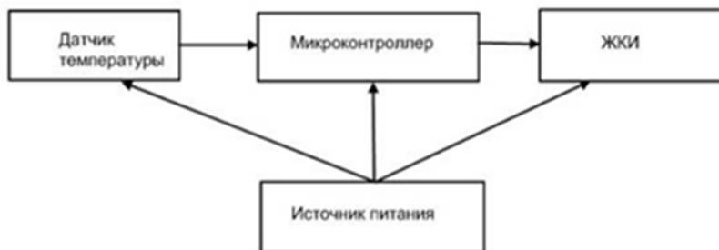
Рис. 1. Структурная схема термометра
