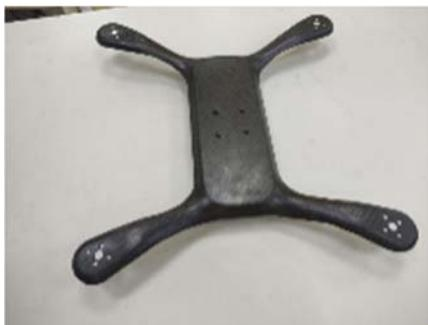
Рис. 5. Готовый корпус БПЛА
