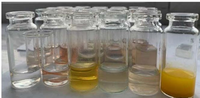
Рис. 7. Качественный анализ присутствия катионов свинца
