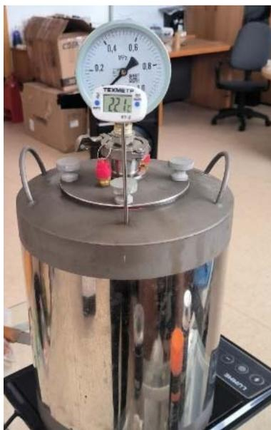
Рис. 1. Собранный автоклавный реактор
