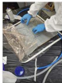
Рис. 4. Сборка вакуумного пакета
