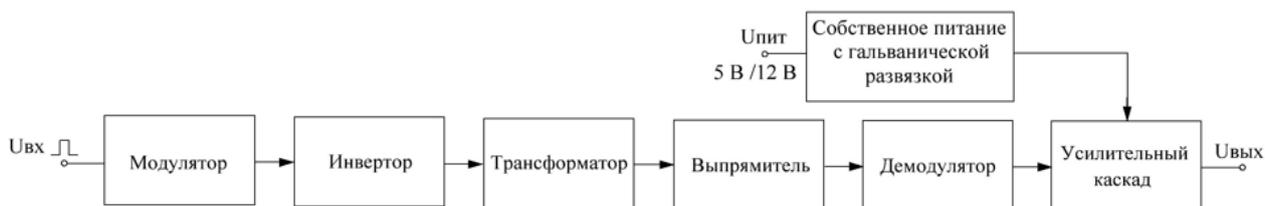
Рис. 4 – Структурная схема силового ключа
