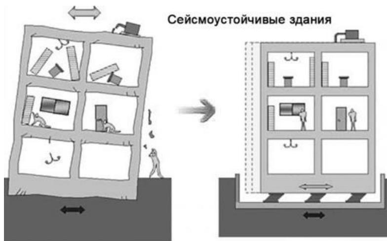
Рис. 2 – Принцип работы сейсмоустойчивых конструкций
