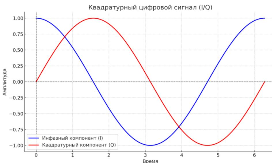
Рис. 1 - График квадратурного цифрового сигнала (I/Q), состоящий из двух ортогональных компонентов
