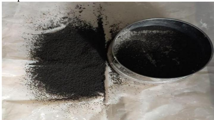
Рис. 2 – Просеивание угольного шлака
