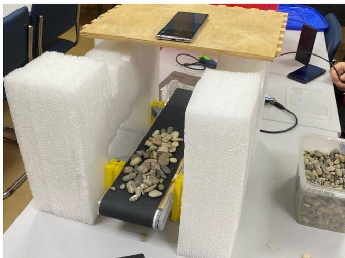
Рис. 1 – Первая версия конвейера
