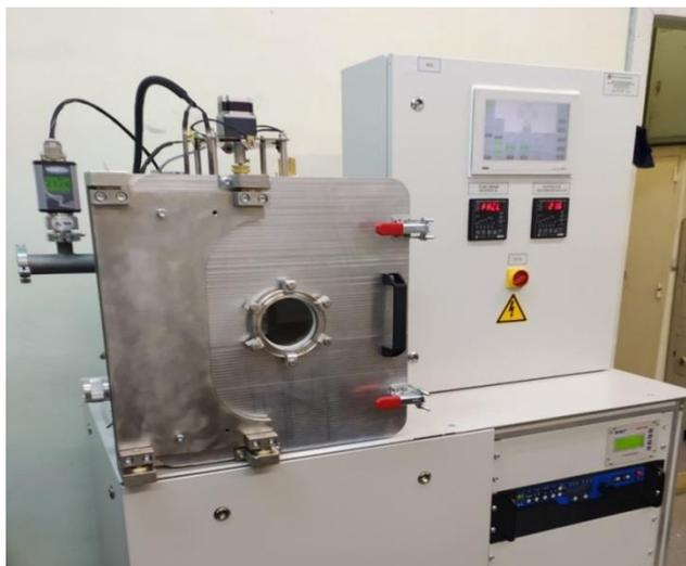
Рис. 2 – Установка вакуумного напыления тонких пленок EPOS-PVD
