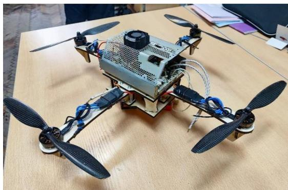
Рис. 5 – Квадрокоптера с блоком питания, этап монтажа
