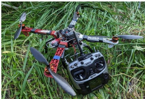
Рис. 3 – Квадрокоптер на базе бюджетного полетного контроллера
