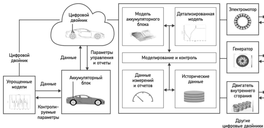
Рис. 1. Концепция цифрового двойника на примере разработки аккумуляторного блока в автомобиле
