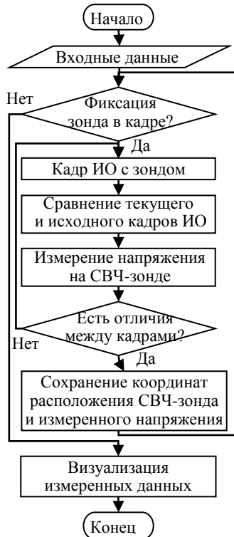
Рис. 2. Алгоритм визуализации уровней излучаемой помехоэмиссии ПП с использованием инструментов компьютерного зрения
