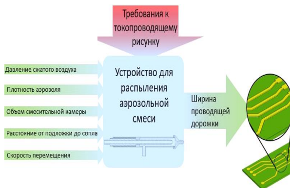
Рис. 2. Модель «черного ящика» устройства для распыления аэрозольной смеси
