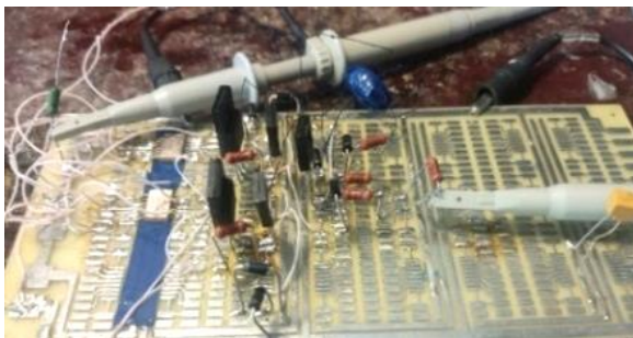
Рис. 3. Изготовленный макет драйвера МОП-транзистора с гальваническим разделением
