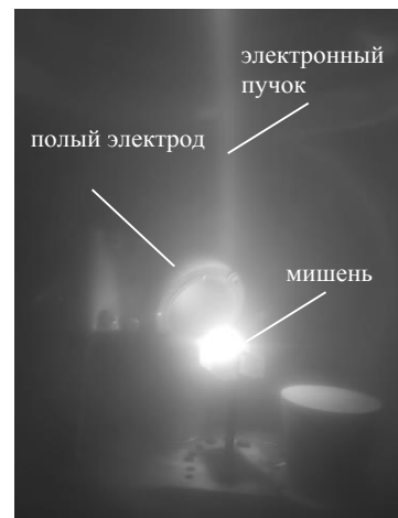
Рис. 1. Схема установки (а) и вид отдельных элементов (б)
