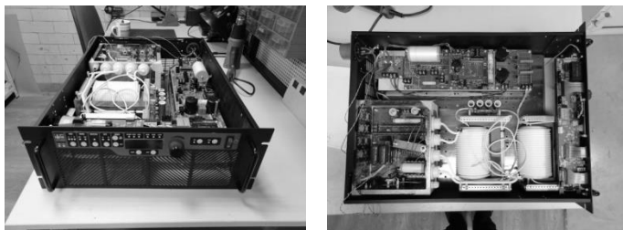
Рис. 2. Внешний вид генератора коротких импульсов высокой мощности для питания импульсного дугового разряда
