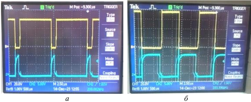
Рис. 4. Осциллограммы напряжений на истоке VT1 (верхняя) и на выходе 1 DD7 (нижняя) при K_3 = 0,1 (а) и K_3 = 0,5 (б)
