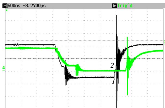
Рис. 2. Оциллограмма напряжения на выходе драйверов: 1 – разрабатываемый драйвер, 2 – драйвер на микросхеме Si8261BCC-C-IP
