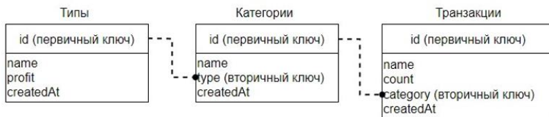
Рис. 1. Полная атрибутивная модель данных финансовой части приложения «Заметки»
