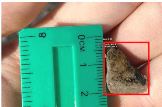
Рис. 2. Определение высоты и ширины щебня
