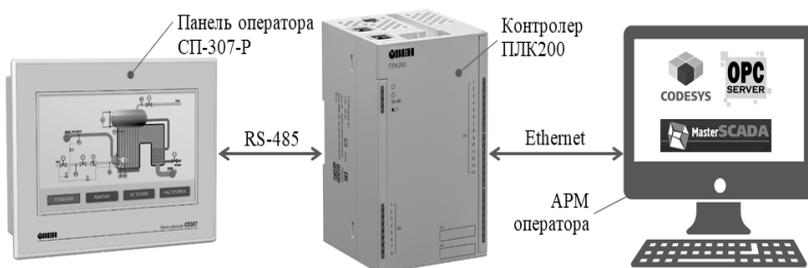
Рис. 2. Структура шита управления
