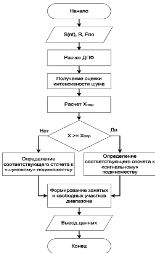
Рисунок 1 – Схема точечного алгоритма
