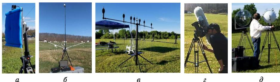
Рисунок 3 – Система акустического обнаружения OptiNav (а); пирамидальная акустическая система (б); двухъярусная перекрестная решетка (в); направленный микрофон с видеокамерой (г); параболические направленные микрофоны (д)
