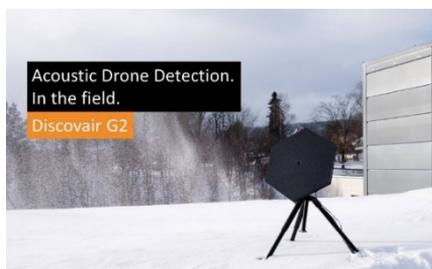
Рисунок 4 – Акустическая система обнаружения дронов Discovair
