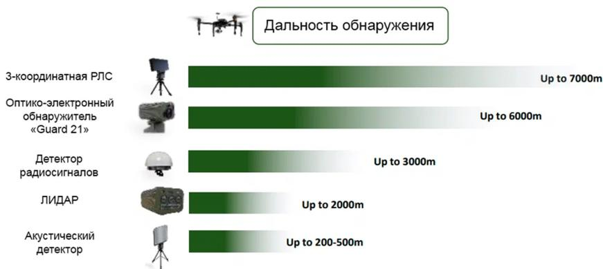
Рисунок 5 – Возможности комплексной системы обнаружения
