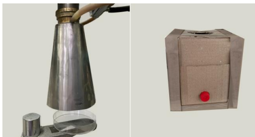
Рис. 1. Конусовидный (слева) концентратор плазмы и кубоид (справа)
