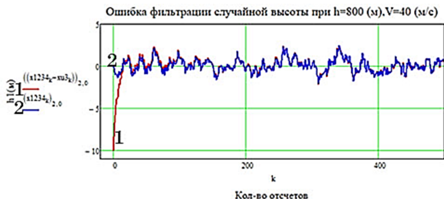
Рисунок 6 – Ошибки фильтрации случайной высоты 800 м (1 – фильтрация, 2 – истинные значения)
