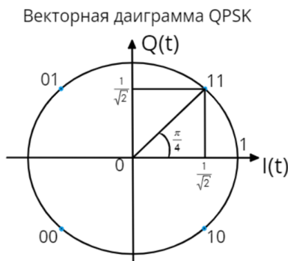
Рисунок 1 – Векторная диаграмма QPSK-сигналов
