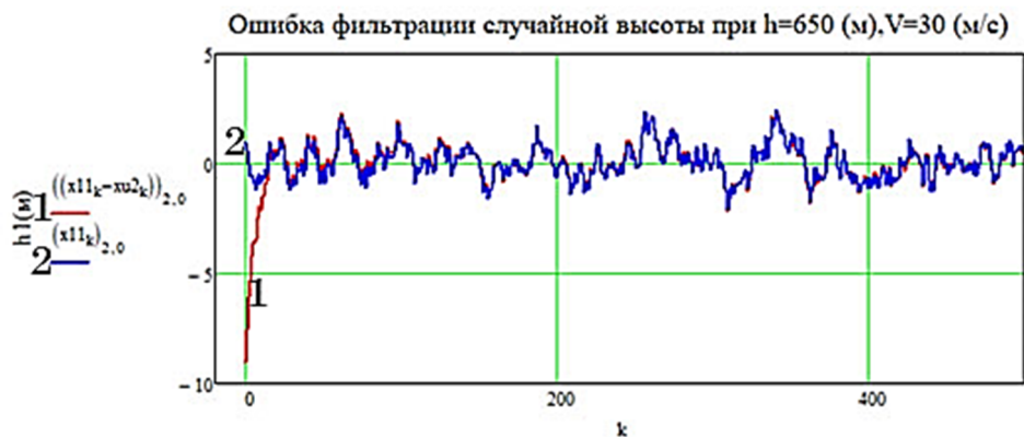
Рисунок 5 – Ошибки фильтрации случайной высоты 650 м (1 – фильтрация, 2 – истинные значения)
