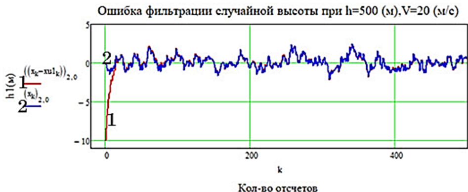
Рисунок 4 – Ошибки фильтрации случайной высоты 500 м (1 – фильтрация, 2 – истинные значения)
