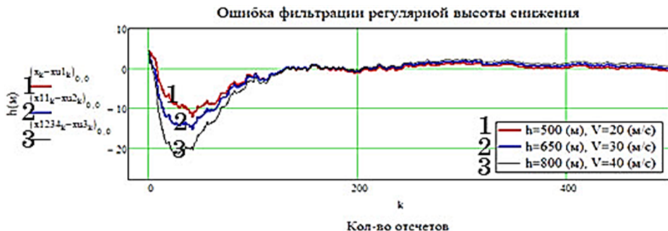
Рисунок 2 – Ошибки фильтрации по высоте (1 – снижение с 500 м, 2 – снижение с 650 м, 3 – снижение с 800 м)
