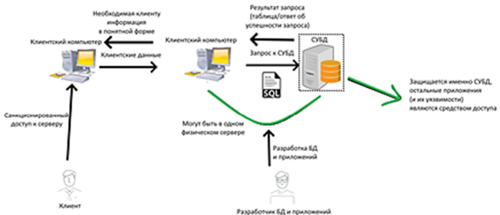
Рисунок 2 – Схема обмена информацией между клиентом и ИС
