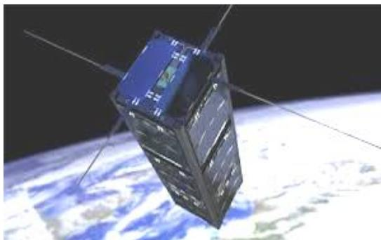
Рис. 1. Наноспутник CubeSat 3 U на орбите
