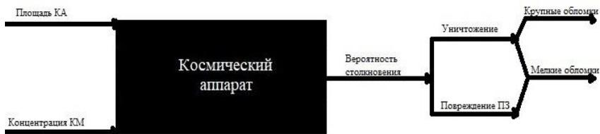
Рис. 1. Модель «чёрный ящик» для космического аппарата
