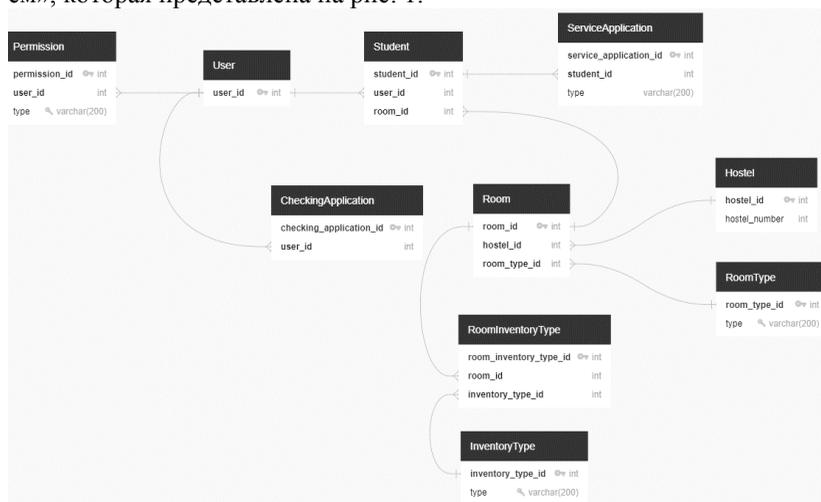
Рис. 1. Визуальное представление архитектуры основных моделей базы данных веб-сервиса «Управление общежитием»
