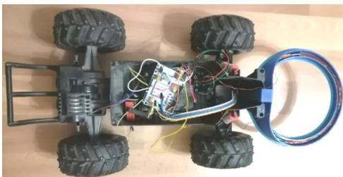
Рис. 2. Изображение устройства с подиумом для крепления металлоискателя
