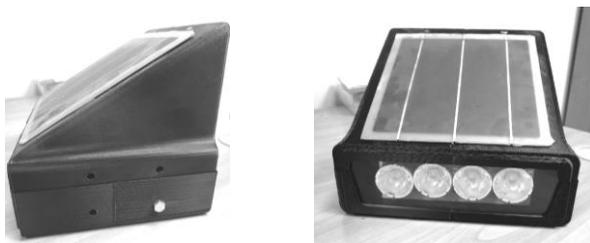
Рис. 3. Макет светового прибора для освещения водных путей
