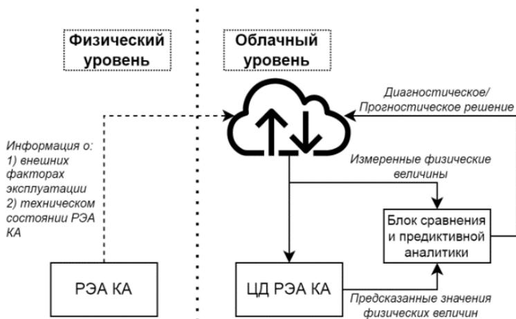
Рис. 3. Схема реализации цифрового двойника
