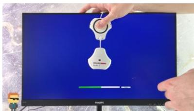
Рис. 6. Калибратор монитора
