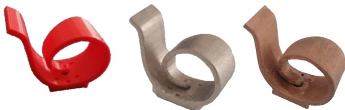
Рис. 2. Металлизация пластиковой детали (антенны)
