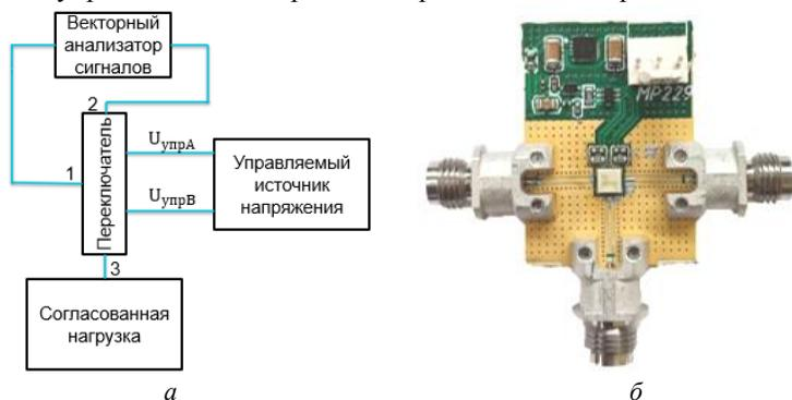
Рис. 2. Схема экспериментальной установки (а) и печатная плата для измерений характеристик MP229 (б)
