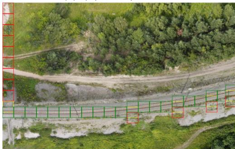
Рис. 2. Часть ортофотоплана и обнаруженные ЖД пути
