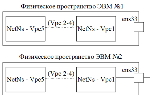
Рис. 1. Модель виртуальной сети в операционной системе GNU/Linux
