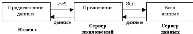
Рис. 1. Трехуровневая архитектура разрабатываемой системы
