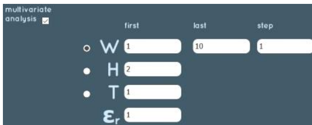
Рис. 2. Поля для ввода минимального и максимального значений ширины ( W ) ЛПП и шага её изменения при многовариантном анализе
