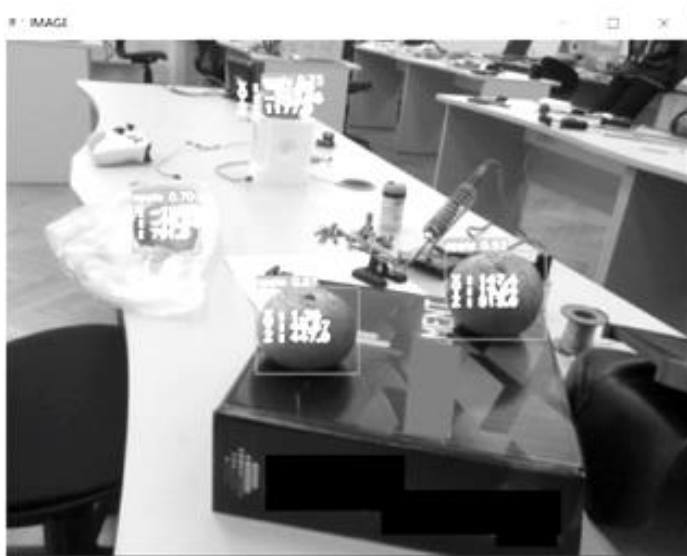
Рис. 2. Обнаружение яблок и определение их координат
