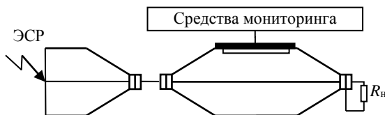
Рис. 2. Схема измерения устойчивости ИС при воздействии ЭСР
