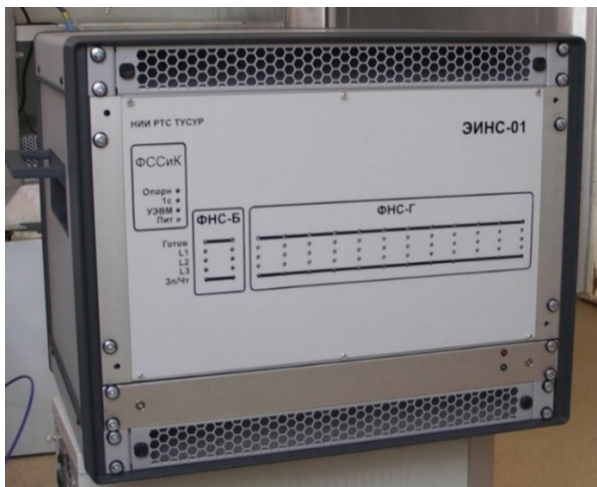
Рисунок 3 — Эталонный источник навигационных сигналов
