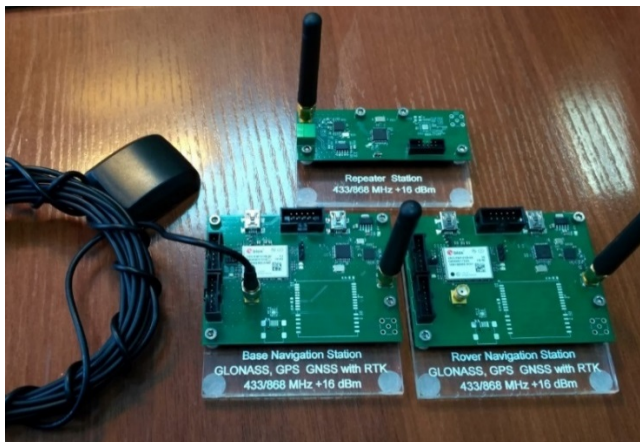
Рисунок 7 — Демонстрационный макет системы навигации для БПЛА
