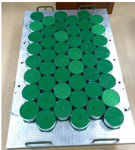
Рисунок 5 — Антенный элемент станции контроля закладки специальной информации и параметров навигационного поля ГЛОНАСС
