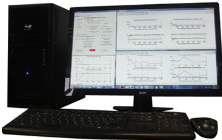
Рисунок 2 – Программно-аппаратный комплекс моделирования процессов позиционирования космических аппаратов в автономном режиме
