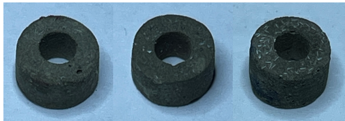
Рисунок 1 — Образцы бетонных радиопоглощающих материалов с порошковыми металлическими наполнителями (слева направо: латунь, сталь, дюралюминий)
