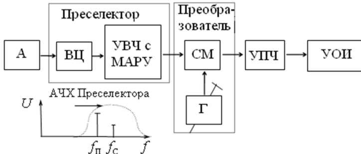
Рисунок 1 — Структурная схема приемника мобильной связи с МАРУ
