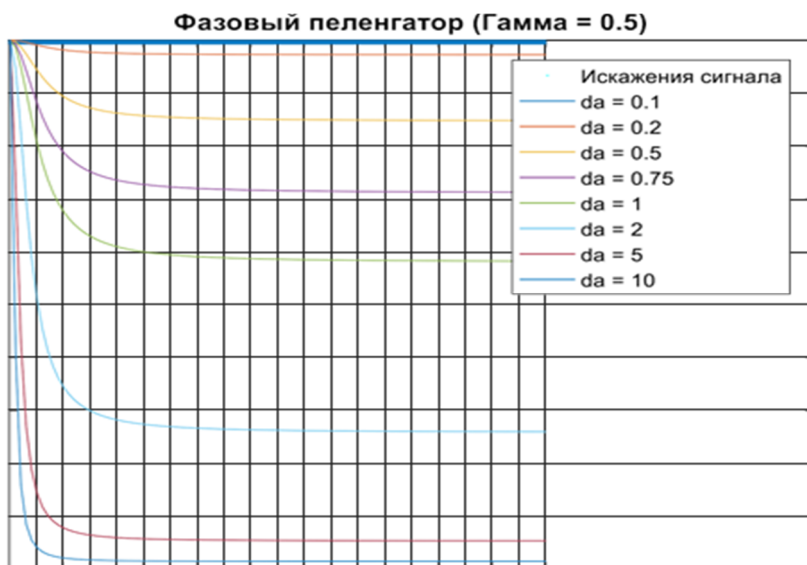
Рисунок 1 — Зависимость относительной эффективности оценки пеленга фазовым пеленгатором от направленности антенны источника h для различных уровней искажения сигнала d
