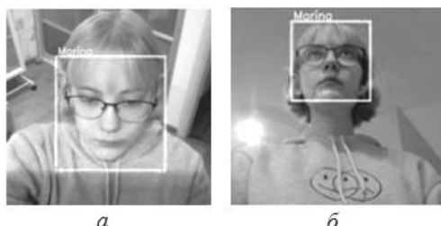
Рис. 5. Результат работы алгоритма автоматической идентификации лиц для статичного положения головы при съемке сверху (а) и снизу (б)
