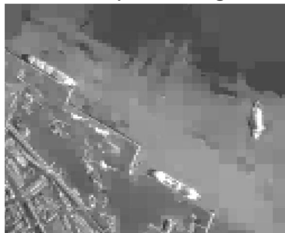
Рис. 4. Пример фрактального кодирования РЛ-изображения «Морского порта»
