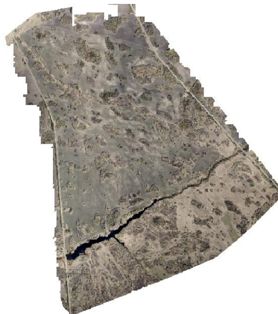
Рис. 4. Фрагмент ортофотоплана, созданного по материалам аэрофотосъемки с БПЛА с помощью Open Drone Map
