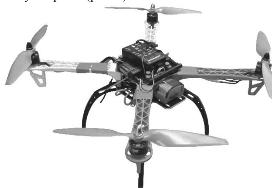
Рис. 1. Внешний вид квадрокоптера на базе полетного контроллера Pixhawk 2.4.8
