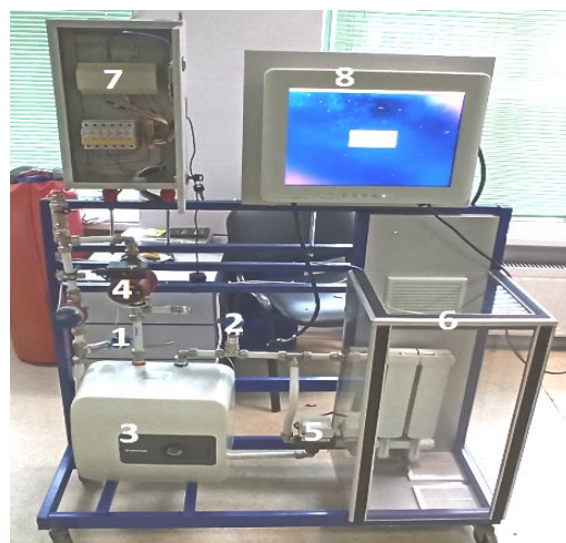
Рис. 1. Рабочий стенд: 1 – термопара (на выход котла); 2 – термопара (на вход котла); 3 – котел; 4 – насос; 5 – клапан; 6 – датчик температуры в помещении; 7 – реле и контроллер; 8 – управляющая ЭВМ
