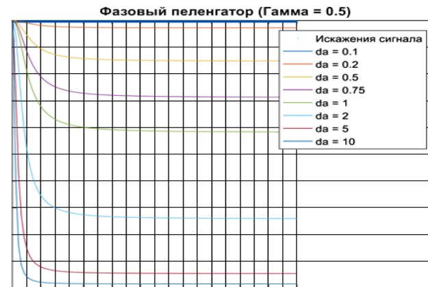
Рис. 1. Зависимость относительной эффективности оценки пеленга фазовым пеленгатором от направленности антенны источника h для различных уровней искажения сигнала d
