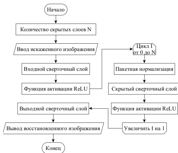
Рис. 2. Архитектура сверточной нейронной сети шумоподавления
