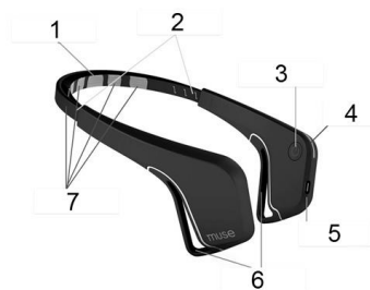
Рис. 1. Внешний вид нейроинтерфейса Muse: 1 – эталонный датчик; 2 – регуляторы размера; 3 – кнопка включения устройства; 4 – светодиоды; 5 – разъем для зарядки устройства; 6 – нейтральные ушные датчики; 7 – лобные гироскопические сенсоры
