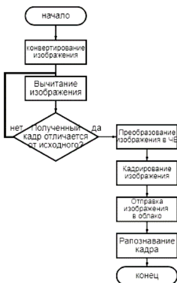
Рис. 1. Блок-схема алгоритма действий по обработке и отправке изображения
