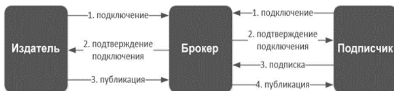
Рис. 1. Схема работы протокола MQTT
