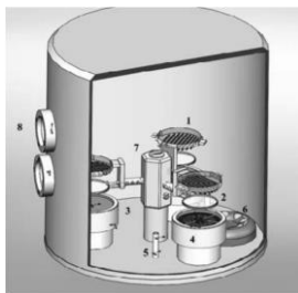
Рис. 1. Устройство рабочей камеры установки напыления
