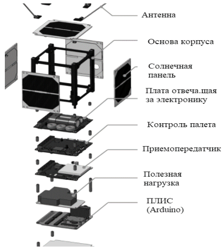
Рис. 1. CubeSat 1U (слева), компоновка CubeSat 1U (справа)
