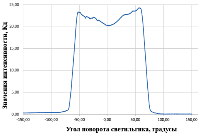
Рис. 1. КСС светильника в вертикальной плоскости
