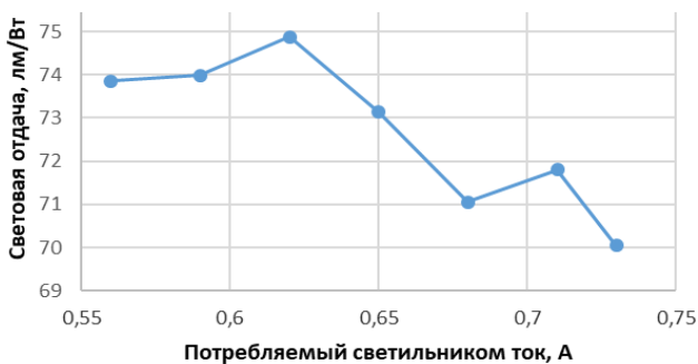
Рис. 3. Зависимость световой отдачи от прямого тока светильника
