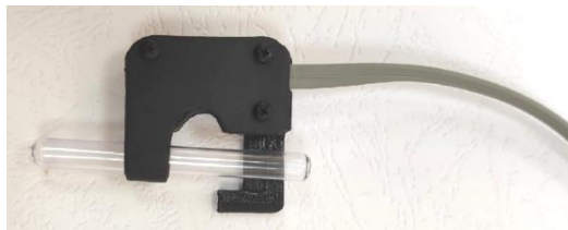
Рис. 2. Макет печатной головки плоттера
