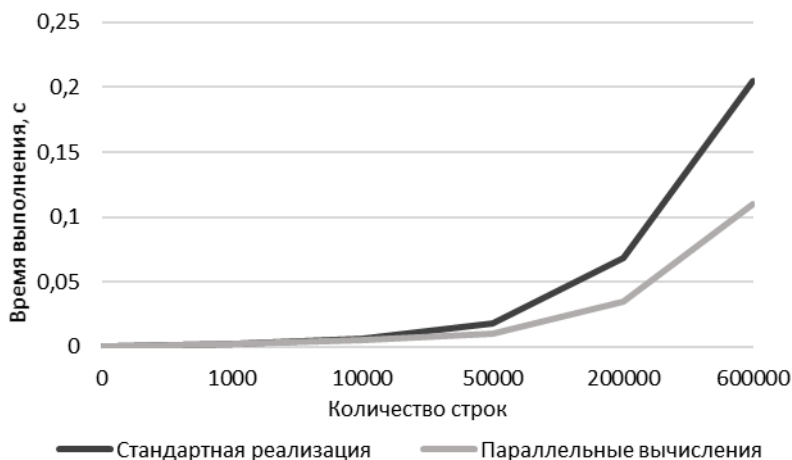
Рис. 2. Результаты оптимизации метода ApplyFilter
