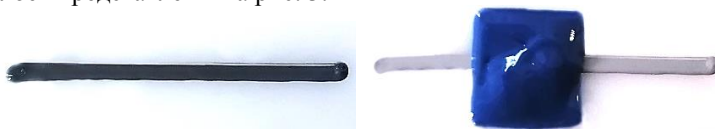
Рис. 3. Нанесение первого проводящего и второго диэлектрического слоёв печатной платы
