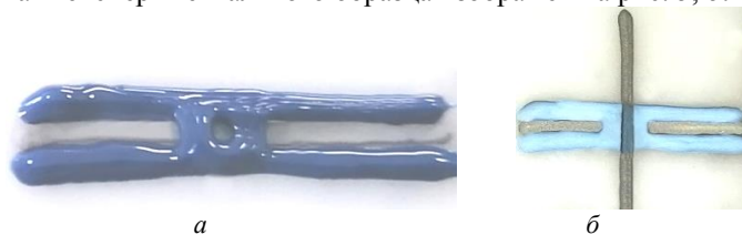
Рис. 5. Многослойная структура печатной платы, созданная методом принтерной печати
