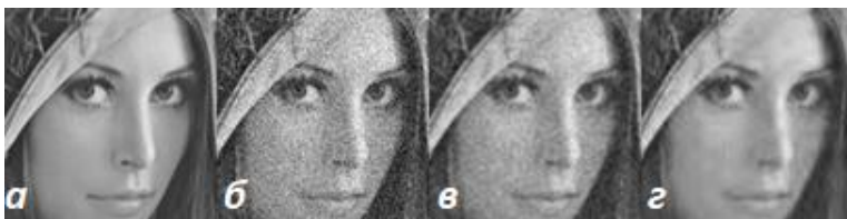
Рис. 2. Чистое (а), зашумленное (б), очищенное усредняющим (в) и очищенное реализованным (г) изображения
