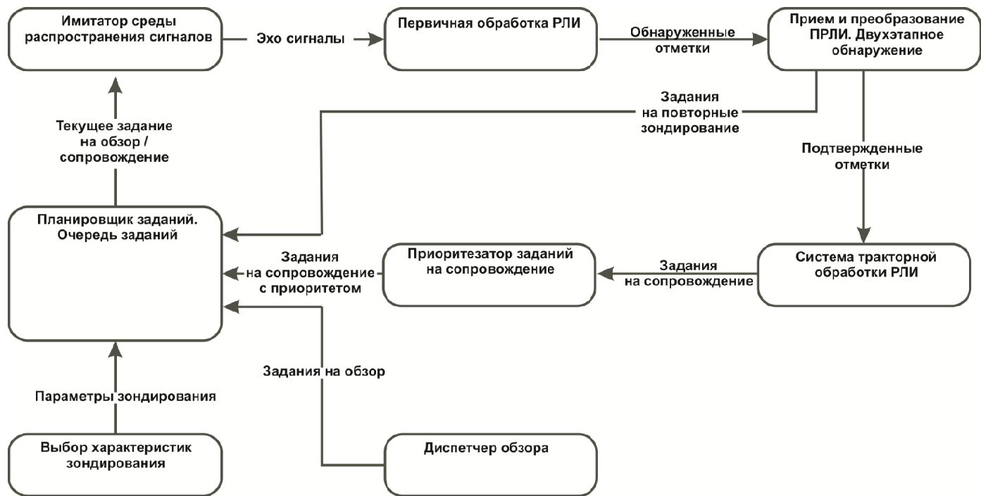
Рисунок 1 — Структурная схема модели УВМ МРЛС
