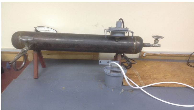
Рисунок 1 — Макет магистрали нефтепровода с запорной арматурой
