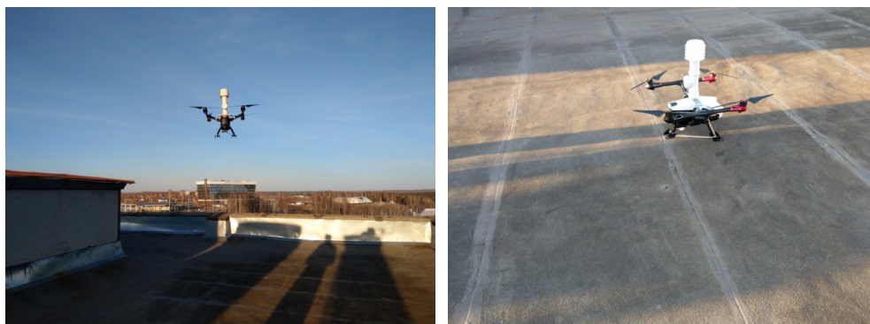
Рисунок 1 — Макет метеоизмерителя на БПЛА в полете ( а ) и на площадке крыши здания ( б )
