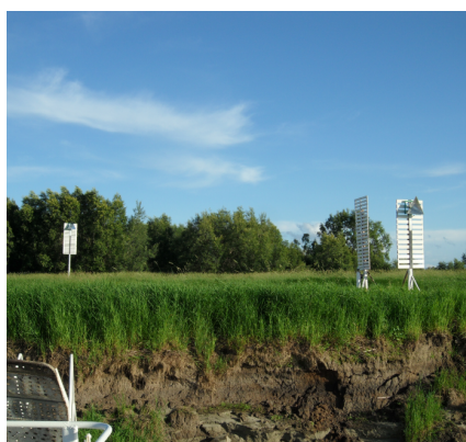
Рисунок 5 — Линейный створ с угловыми РОО ( a ). Радиолокационное изображение линейного створа с угловыми РОО на ИКО НРЛС «Р-722-2» ( б ). Дальность до линейного створа — 750 м. Река Обь. Канангинский перевал
