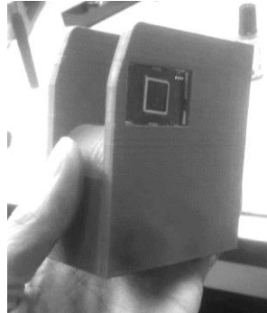
Рис. 2. Биометрический датчик прототипа в корпусе, напечатанном на 3D-принтере
