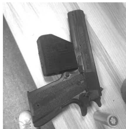
Рис. 7. Вторая версия кейса на макете пистолета
