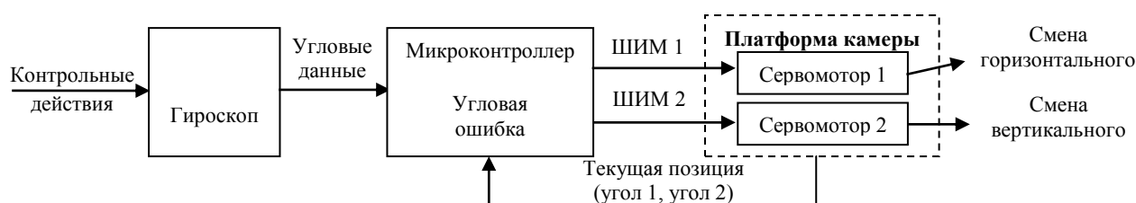
Рис. 1. Функциональная схема следящей системы видеонаблюдения
