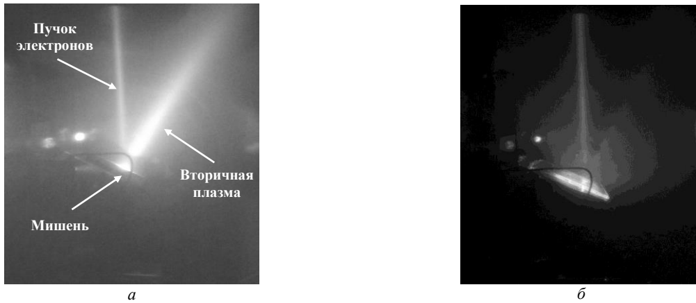
Рис. 2. Картина, наблюдавшаяся в вакуумной камере для различных типов мишеней: изолированной проводящей (а) и диэлектрической (б)
