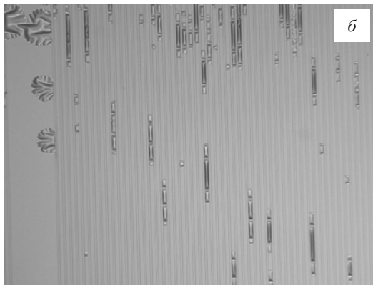
Рис. 6. Фотографии вида сверху образцов с пленками WSi, нанесенными в режиме постоянного тока (а) и в импульсном режиме (б), после выдержки в стакане с ДМФА, нагретым до 100 °С, в течение 1 мин
