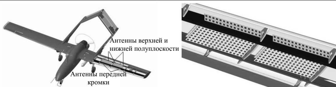
Рис. 2. Конформное расположение АФАР на крыльях БПЛА
