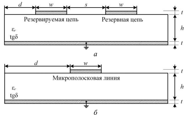
Рис. 1. Поперечное сечение структуры с однократным МР (а) и без него (б)
