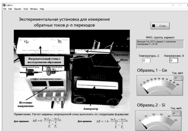
Рис. 5. Панель симулятора лабораторного стенда «Определение ширины запрещенной зоны полупроводника методом измерения обратных токов электронно-дырочного перехода»
