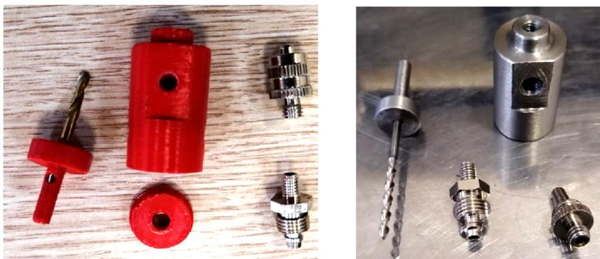
Рис. 2. Гильза дозатора, изготовленная из пластика (слева) и из стали (справа)
