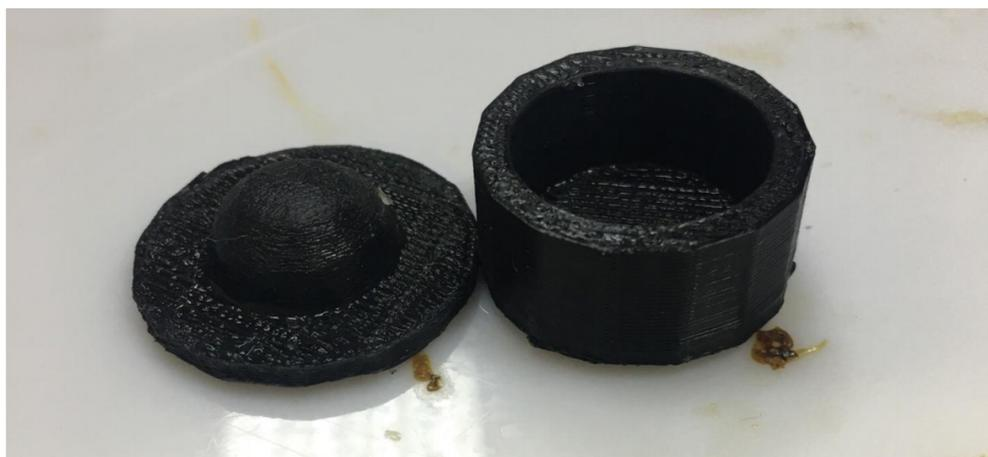
Рис. 5. Готовый образец формы для заливки линзы
