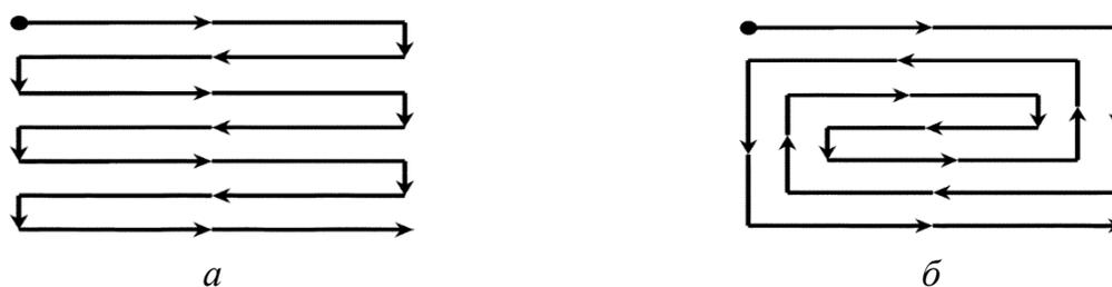
Рис. 1. Две классические схемы трассировки линий задержки: меандр (а) и спираль (б)
