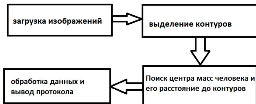
Рис. 1. Блок схема этапов работы алгоритма
