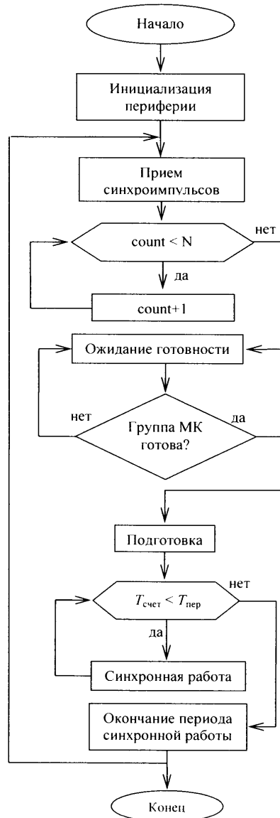
Фиг. 2. Алгоритм работы микроконтроллера
