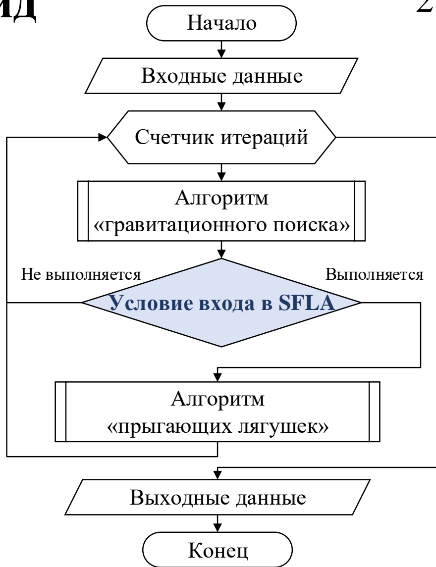
Рисунок 3 – Схема гибридного алгоритма
