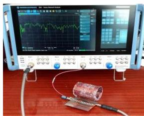
Рис. 5. Лабораторный макет для измерения параметров ЭС
