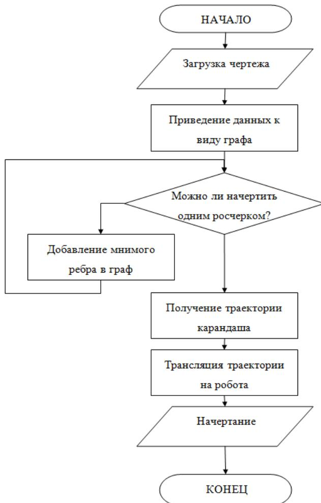
Рис. 2. Блок-схема алгоритма работы устройства
