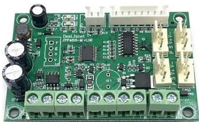
Рис. 2. ШИМ-регулятор скорости вращения вентиляторов с интерфейсом RS-485
