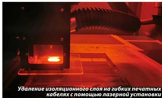
**Удаление изоляционного слоя на гибких печатных кабелях с помощью лазерной установки**
