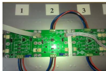
Рисунок 3 – Лабораторный макет для исследования инвертирующего усилителя
