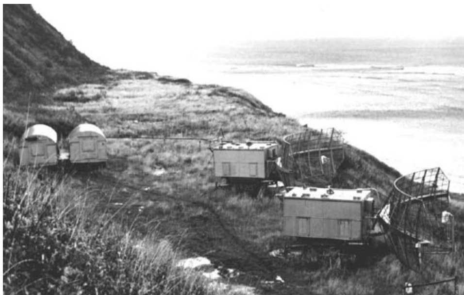
Рисунок 6 – Передающая часть экспериментальной системы «Пересекающиеся трассы» (сантиметровый диапазон). п. Взморье (о. Сахалин)
