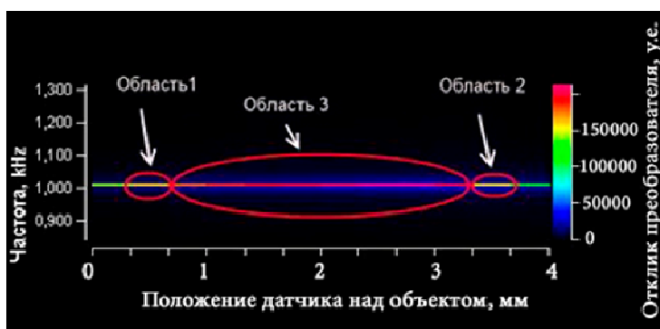
Рисунок 1 – Спектральная картина, возникающая при перемещении датчика над слоистой средой с дефектом
